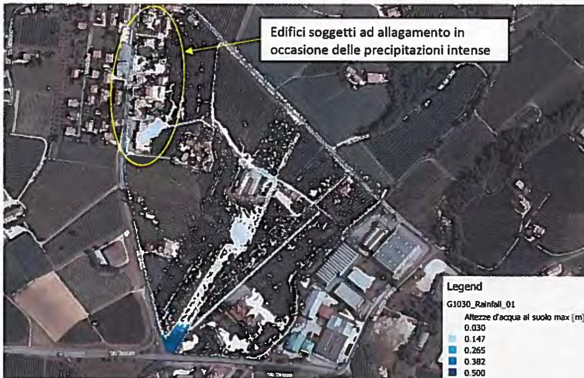
Figura 5.24 – Area a ristagno idrico da modello idraulico TR=50 anni
