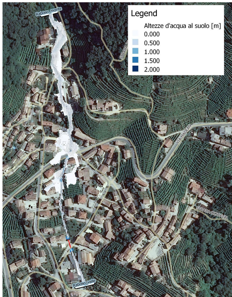
Figura 3.29 – Aree allagabili dopo 20 minuti ( Q=1\text{m}^3/\text{s} )
