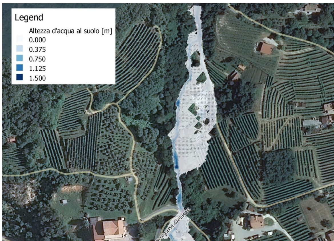
Figura 3.7 – Aree allagabili a monte della Sp 36
