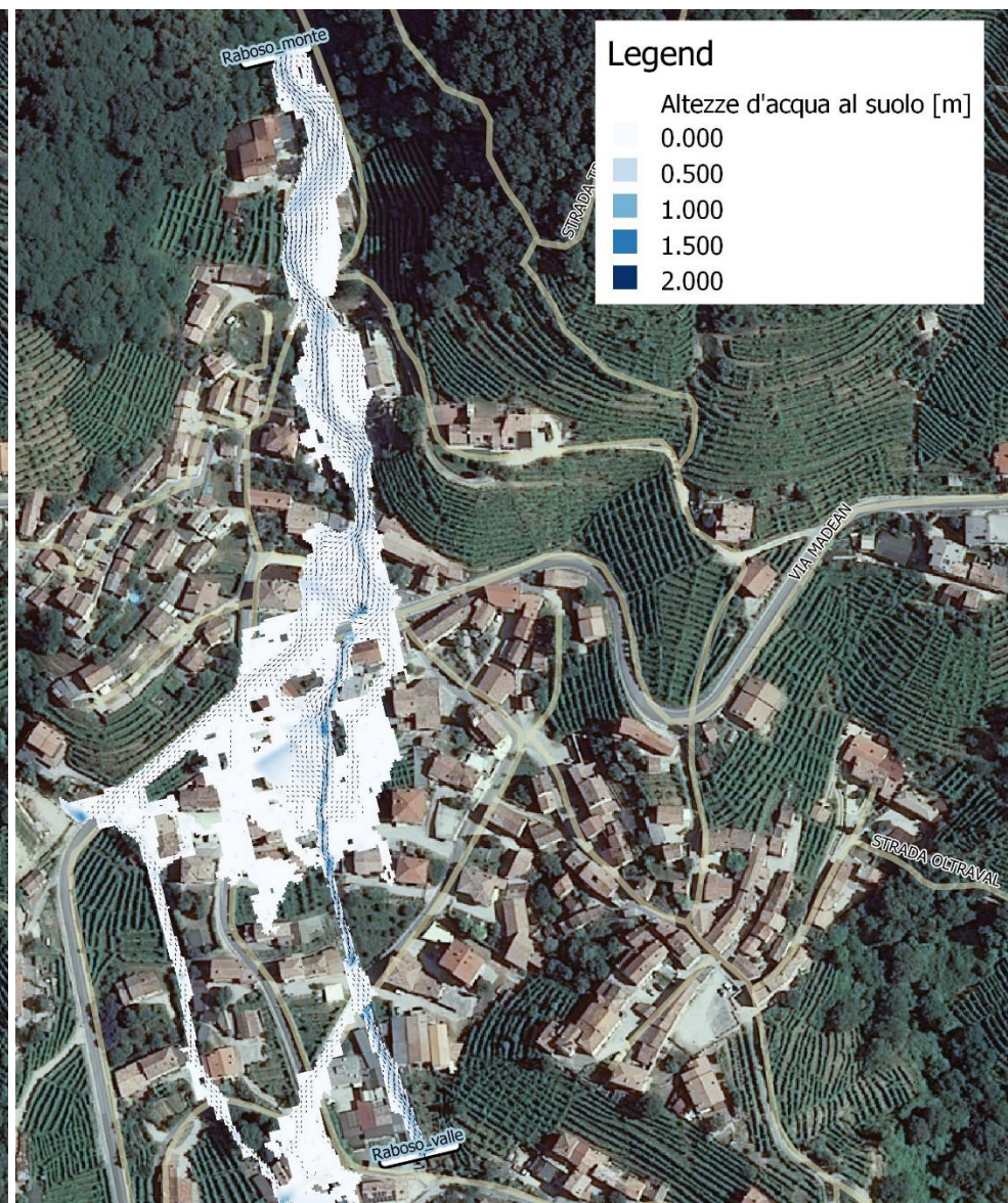
Figura 3.30 – Aree allagabili dopo 60 minuti ( Q=10\text{m}^3/\text{s} )
