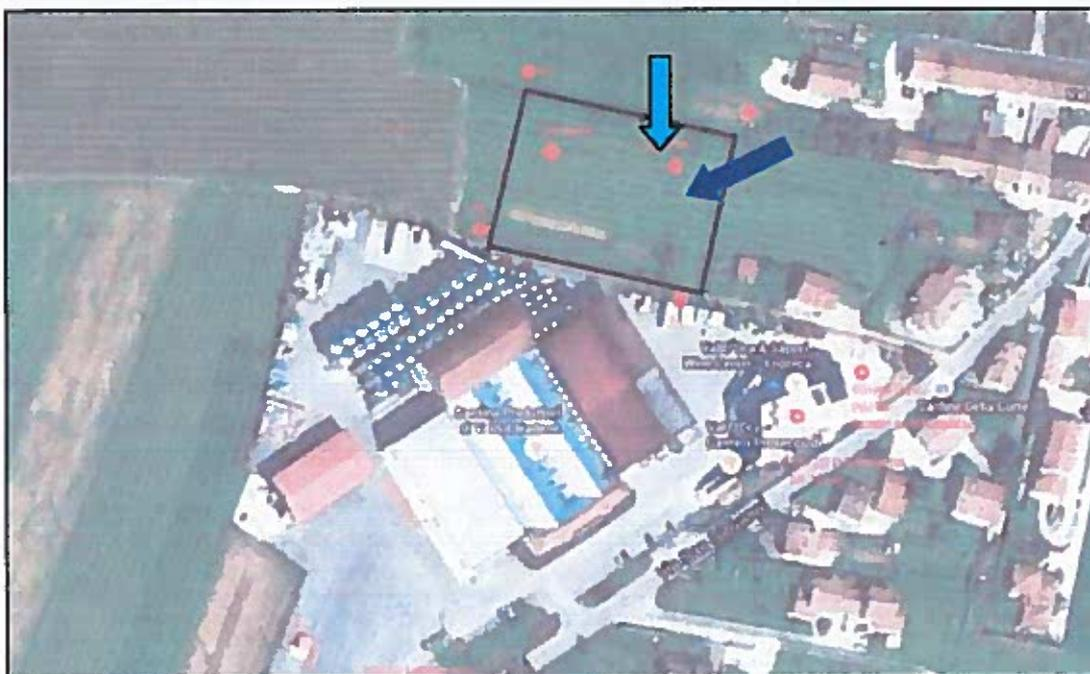
Circolazione idrica profonda in corrispondenza dell'area di intervento: con la freccia azzurra la direzione prevalente degli apporti idrici nel livello ghiaioso superficiale (Livello A) ed in blu quella generale degli apporti idrici racchiusi negli interstati ghiaiosi all'interno dei depositi argillosi (Livello B)
